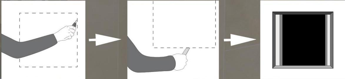
Bei Montage der Wandnische in festes Mauerwerk arbeiten Sie eine passende Aussparung heraus. Achten Sie auch auf eine Anlagefläche für die Außenflanken der Wandnische, zur späteren bündigen Befestigung mit der Wand.
